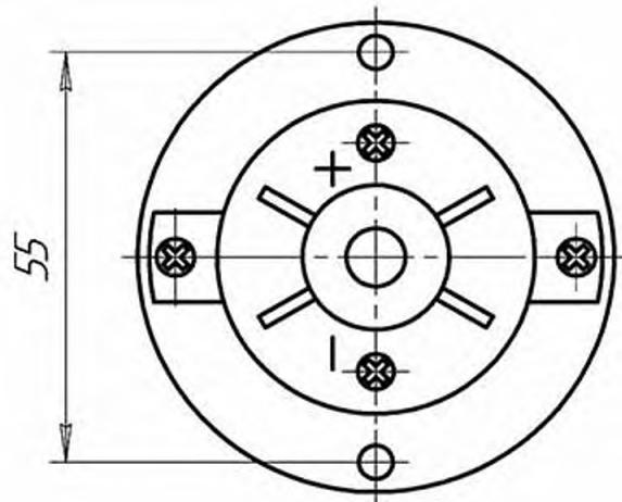
5.2. При превышении температуры окружающей среды срабатывает элемент термочувствительный (1), который освобождает в корпусе (2) подпружиненный шток (3). На штоке закреплен магнит (4), который проходит через индукционную катушку (5) и вырабатывает в ней импульс, через контакты (6), поступающий по соединительным проводам на побудительную систему установки пожаротушения и/или средства сигнализации.
