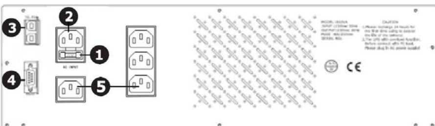
В источниках бесперебойного питания в корпусе Rack Mount для подключения нагрузки используются розетки стандарта IEC 320 C13
