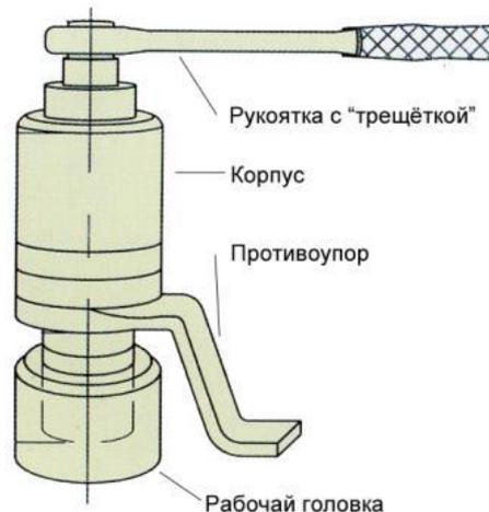
Принцип действия мультипликатора крутящего момента основан на свойствах редуктора планетарного действия и использовании силы реакции опоры (противоупора). Противоупор закреплён к нижней части корпуса редуктора. Редуктор имеет несколько ступеней усиления, дающих в совокупности общий коэффициент усиления, выраженный через передаточное число.
