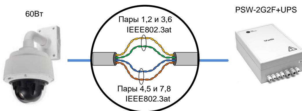
Рисунок 3.3.1 - Схема питания по PoE+ (60 Вт)
