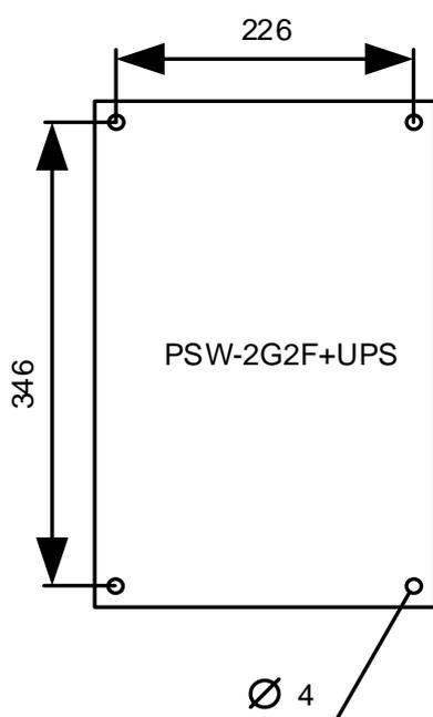
Рисунок 7.1.1. Разметка крепления
