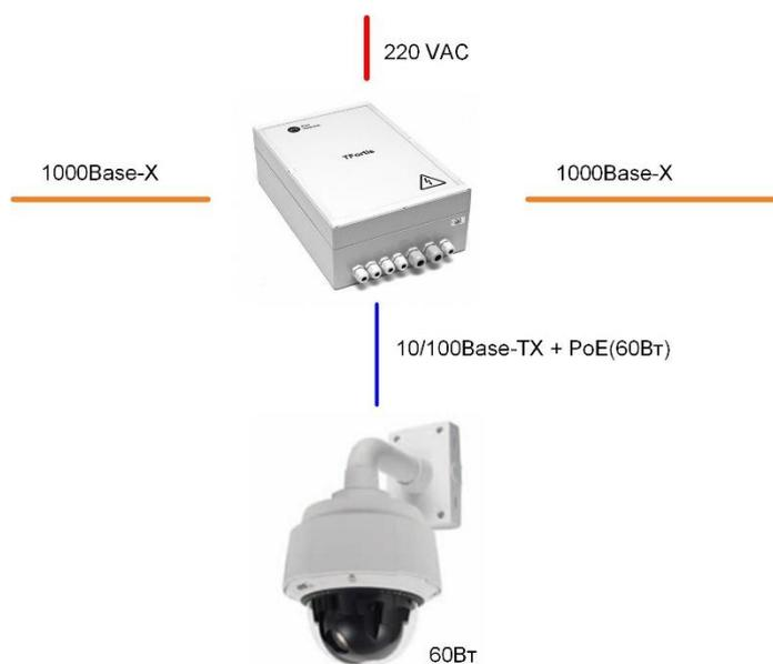
Рисунок 1.1 - Схема подключения одной камеры с потреблением 60 Вт.
