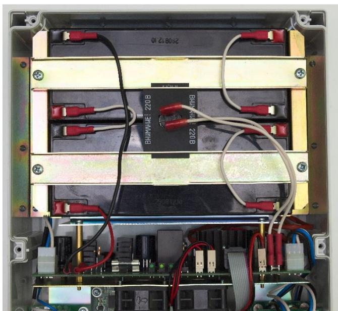
Рисунок 3.8.5 - Подключение АКБ.
