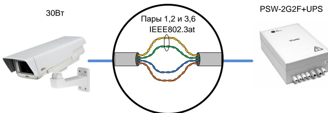
Рисунок 3.3.2 - Схема питания по PoE+ (30 Вт)
