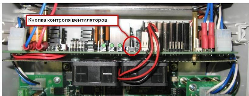
Рисунок 3.8.6 - Проверка работоспособности вентиляторов.
