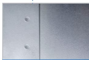
**Точечная сварка** Надежное соединение листа внахлест без воздушного зазора
