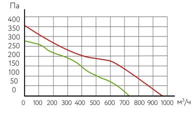
Данные аэродинамичекских характеристик приведены для температуры сухого воздуха 20°С и атмосферного давления 760 мм.рт.ст.
