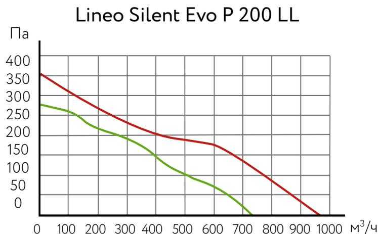
Данные аэродинамических характеристик приведены для температуры сухого воздуха 20°C и атмосферного давления 760 мм.рт.ст.
