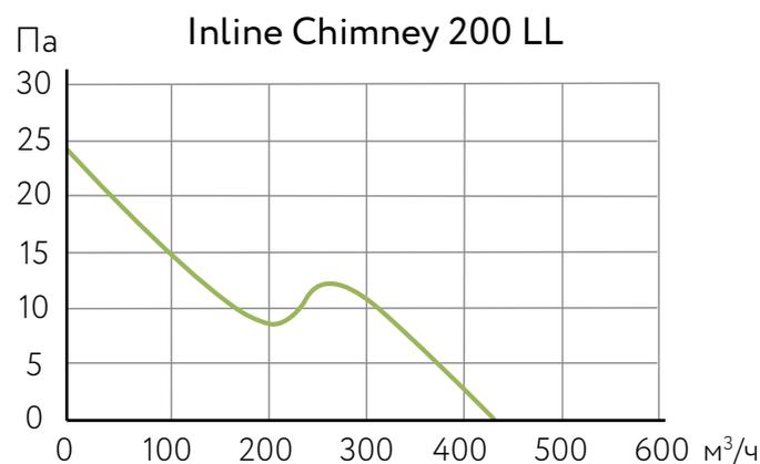
Данные аэродинамических характеристик приведены для температуры сухого воздуха 20°С и атмосферного давления 760 мм.рт.ст.
