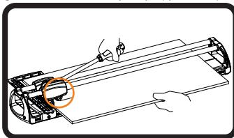
Каретку провести вдоль разметки по направлению к упору с небольшим нажимом. Допускается проводить роликом по поверхности плитки только один раз, иначе рез может получиться неровным. Характерным признаком, верно выбранного усилия будет равномерный треск реза глазури плитки;
