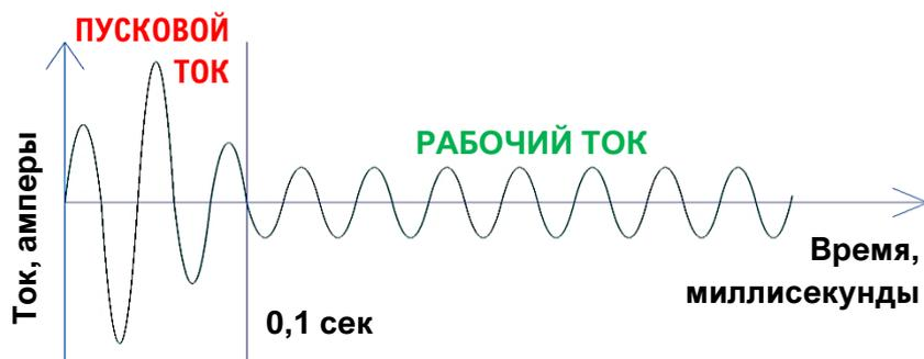
Пусковые токи необходимы для запуска, но несут с собой лишь негативные последствия, такие как перегрузка и перегрев электропроводки, прогорание плохо закрученных контактов, выход из строя электронных компонентов (конденсаторы, транзисторы, реле и др.).
