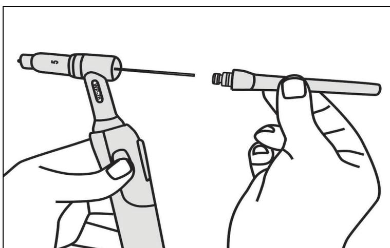
Рис. 12. Сборка горелки
