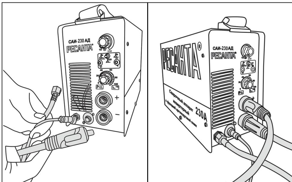
Рис. 6. Подключение кабелей в режиме сварки TIG
