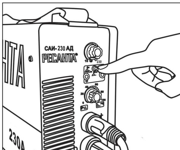
Рис. 7. Установка тумблера для сварки в режиме TIG
