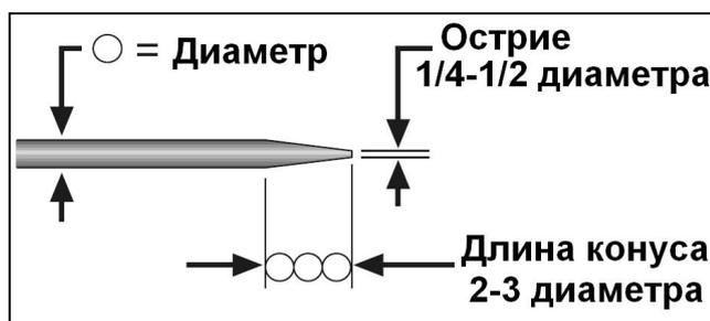
Рис. 14. Рекомендованный диаметр электрода
