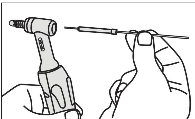
Рис. 11. Сборка горелки
