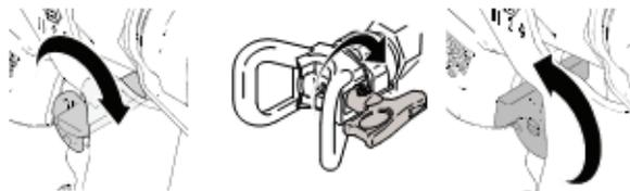
2. Наденьте предохранитель. Верните поворотный наконечник SwitchTip в исходное положение. Снимите предохранитель и продолжайте распыление.
