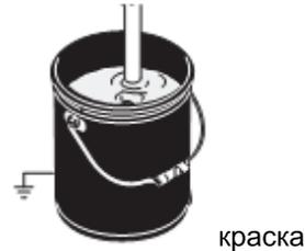
8. Нажимайте на спусковой механизм краскораспылителя, пока не появится краска. Перенесите краскораспылитель в ведро с краской и нажимайте на спусковой механизм в течение 20 секунд. Активируйте предохранитель краскораспылителя. Установите наконечник и предохранитель наконечника, см. инструкции на следующей странице.
