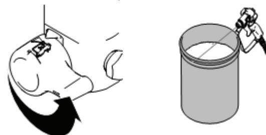
7. Поднимите трубку сифона выше уровня промывочной жидкости и дайте распылителю поработать в течение 15 – 30 секунд, чтобы слить жидкость. Выключите питание.
