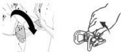
3. Установите регулятор давления на самое низкое значение. Нажмите на спусковой механизм краскораспылителя, чтобы сбросить давление.
