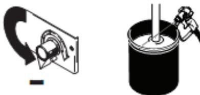
4. Поместите сливную трубку в ведро. Поверните вниз заливочный клапан в положение DRAIN /слив.
