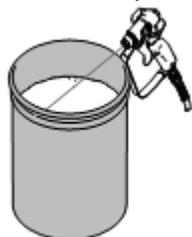
5. Поверните заливочный клапан в положение DRAIN/слив и дайте промывочной жидкости поциркулировать, пока из распылителя не пойдет чистая промывочная жидкость.
