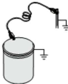
**Чтобы сохранить непрерывность заземления при сбросе или уменьшении давления:** плотно прижмите металлическую деталь краскораспылителя к стенке заземленного металлического ведра. Затем нажмите на спусковой механизм краскораспылителя.
