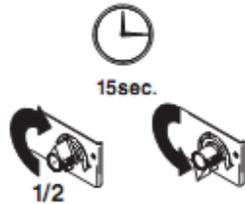
4. Поверните заливочный клапан вперед в положение SPRAY / распыление. Деактивируйте предохранитель спускового механизма.
