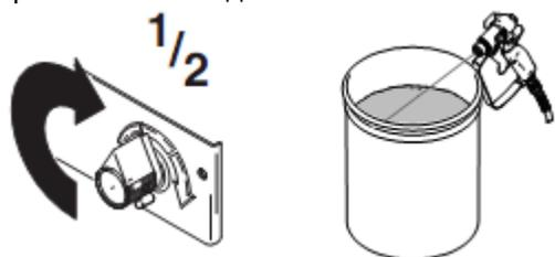
4. Переместите краскораспылитель в пустое ведро, прижмите его к стенке ведра, нажмите на спусковой механизм, чтобы тщательно промыть систему. Отпустите спусковой механизм и наденьте предохранитель спускового механизма.
