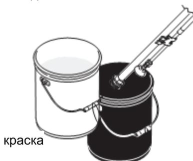
8. Поверните заливочный клапан в положение DRAIN/слив. Отсоедините краскораспылитель от сети, вынув вилку из розетки.
