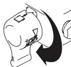
10. Погрузите насос в заземленное металлическое ведро, частично заполненное промывочной жидкостью. Прикрепите заземляющий провод к ведру, а другой конец к заземлению на грунт. Выполните шаги 1 – 5 процедуры **Запуска**, чтобы смыть консервирующую смазку, которой был смазан распылитель для транспортировки. Используйте воду для удаления краски на водной основе и уайт-спирит для удаления краски на масляной основе и консервирующей смазки.
