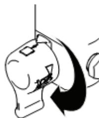
6. Поверните заливочный клапан вперед в положение SPRAY / распыление. Нажмите на спусковой механизм краскораспылителя, направив распылитель в ведро с промывочной жидкостью, чтобы удалить жидкость из шланга.
