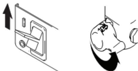
3. Увеличьте давление на 1/2. Прижмите краскораспылитель к стенке ведра с краской. Снимите предохранитель спускового механизма. Нажимайте на спусковой механизм краскораспылителя, пока из него не пойдет промывочная жидкость.
