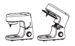
2. Поверните ручку фиксации моторного отсека против часовой стрелки, и откиньте моторный отсек вверх.
