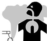
Les fumées, gaz et poussières émis par le soudage sont dangereux pour la santé. Il faut prévoir une ventilation suffisante, un apport d'air est parfois nécessaire. Un masque à air frais peut être une solution en cas d'aération insuffisante. Vérifier que l'aspiration est efficace en la contrôlant par rapport aux normes de sécurité.
