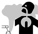
I fumi, gas e polveri emesse dalla saldatura sono pericolosi per la salute. È necessario prevedere una ventilazione sufficiente e a volte è necessario un apporto d'aria. Una maschera ad aria fresca potrebbe essere una soluzione in caso di aerazione insufficiente. Verificare che l'aspirazione sia efficace controllandola in relazione alle norme di sicurezza.
