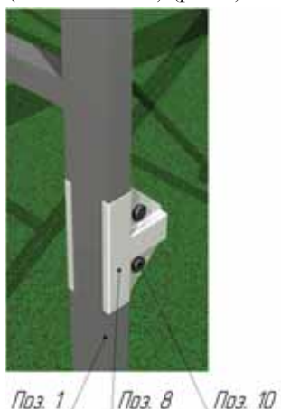
Рис. 7. Монтаж крепления-спайдер «Т-образного»
