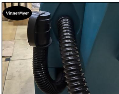
Когда бак для грязной воды заполнится, опорожните бак с помощью сливного шланга. Только после этого пополните бак чистой воды
