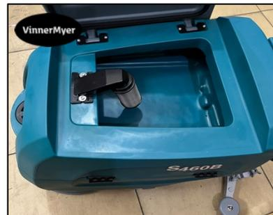
После окончания уборки – промойте бак грязной воды, протрите резинки скребка и промойте щетку
