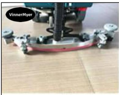
Установите скребок на машину, зафиксируйте барашками. Подсоедините всасывающий шланг к скребку.
