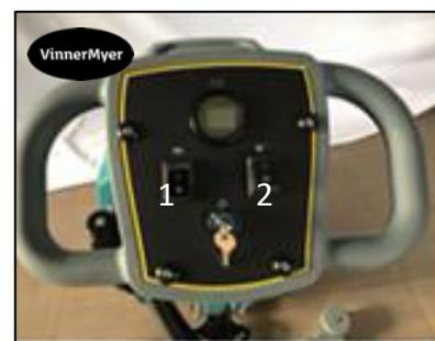
Включите привод щетки(2) и вакуумный мотор(1) с помощью соответствующих кнопок
