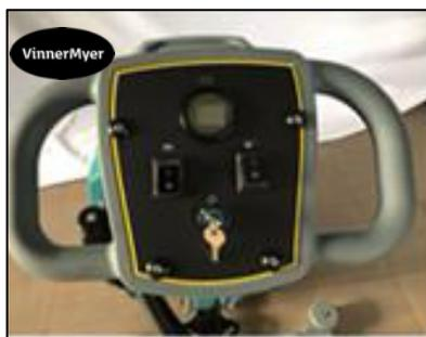
Вставьте ключ в замок зажигания и поверните в положение ON
