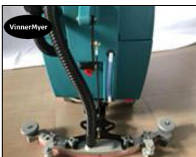
Опустите щетку в рабочее положение. С помощью рычага опустите водосборную балку
