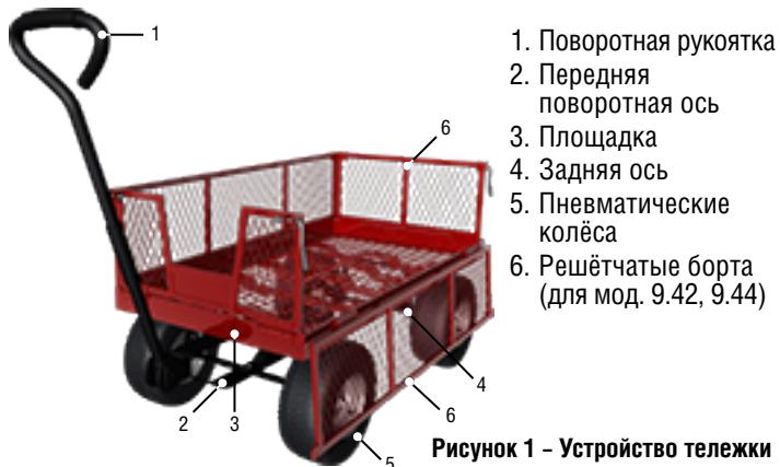
Рисунок 1 – Устройство тележки
