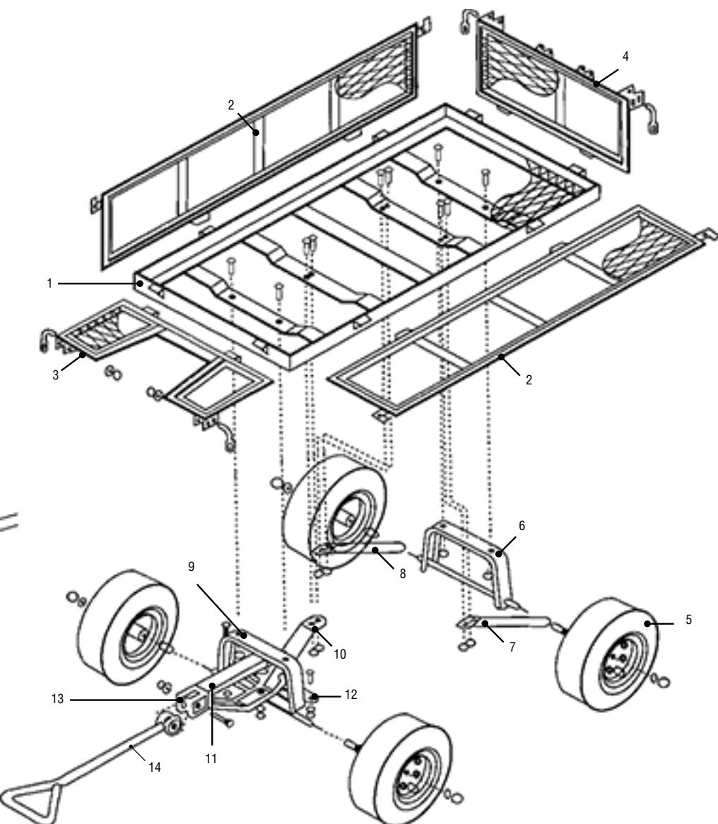
Рисунок 2 – Сборка тележки
