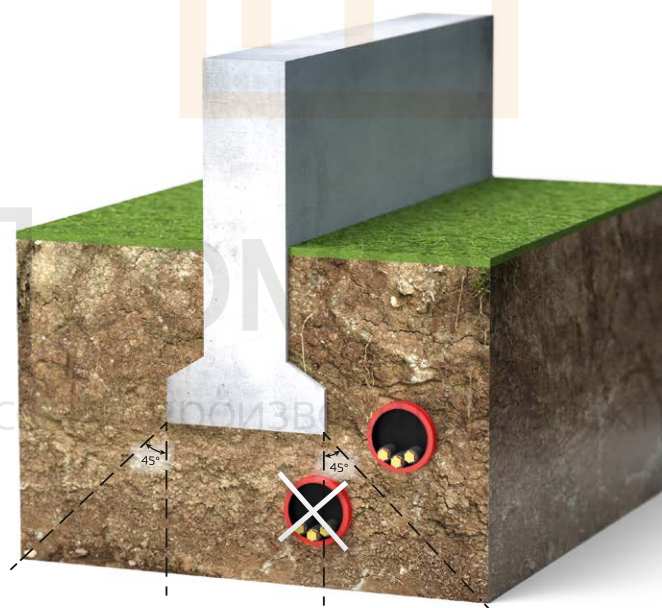
Рисунок №7. Прокладка труб вблизи фундаментов
