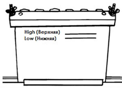
Если электролита в аккумуляторе недостаточно, электродвигатель перестанет работать из-за недостаточного напряжения. Таким образом, держите уровень жидкости между верхними и нижними отметками.
