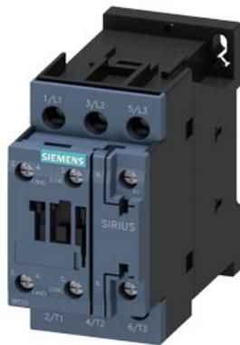
Силовой контактор, AC-3 32 A, 15 кВт/400 В 1 НО + 1 НЗ, 24 В AC, 50 Гц 3-полюсн., типоразмер S0 винтовой зажим
