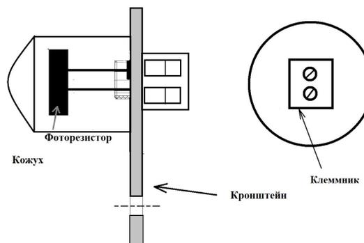
Рис. 3. Схема сборки фотодатчика
