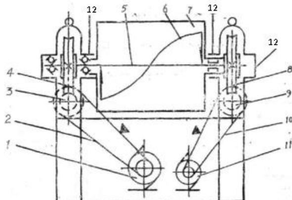
Принцип действия тестомесильной машины — емкость для приготовления теста (дежа) имеет горизонтальный вал, на котором размещены лопасти в форме S или J. Лопасти. За счёт вращения лопастей происходит смещивание продуктов и приготовление теста. Степень приготовления оператор определяет визуально.
