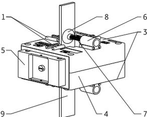
Рисунок 3. Схема установки трансформаторов серии ТТ-В на шине
