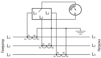
Рисунок 4. Схема подключения амперметра через трансформаторы тока
