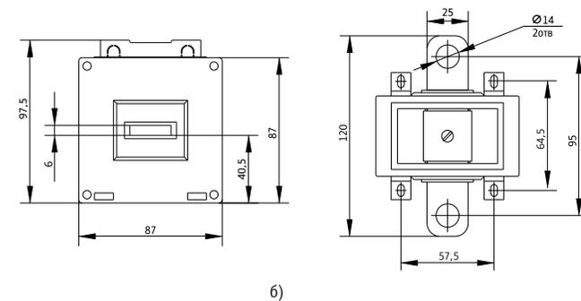
Рисунок 2. Габаритные и установочные размеры трансформаторов: а)ТТ-А-30/5А ... ТТ-А-300/5А; б)ТТ-А-400/5А ... ТТ-А-600/5А.
