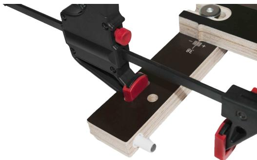
Дверь фиксируется держателями дверного полотна, (в комплект не входят) шаблонодержатель упираясь ограничителем в край дверного полотна, устанавливается сразу на месте врезки, на расстоянии 250 мм от края до центра петли. Наносится обозначение, которое должно совпадать с соответствующей меткой на шаблонодержателе.
