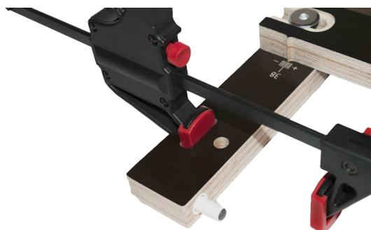
Дверь фиксируется держателями дверного полотна, (в комплект не входят) шаблонодержатель упираясь ограничителем в край дверного полотна, устанавливается сразу на месте врезки, на расстоянии 250 мм от края до центра петли. Наносится обозначение, которое должно совпадать с соответствующей меткой на шаблонодержателе.
