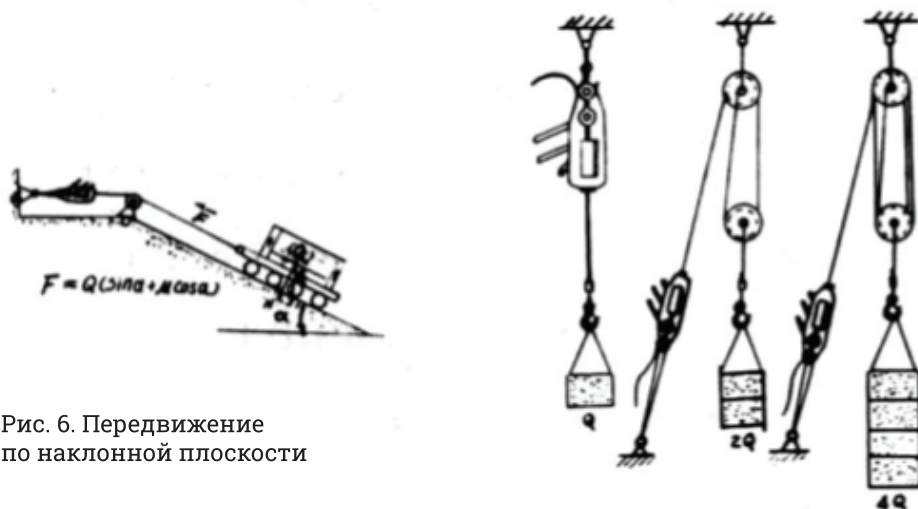
Рис. 5Г. Опустить груз или перемещать груз назад: нажать рычаг назад (черный цвет – захват, белый – отпустить)
