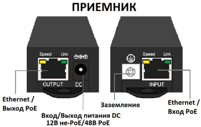
Рис. 2.2. Расположение и назначение элементов коммутации. Приемник.
