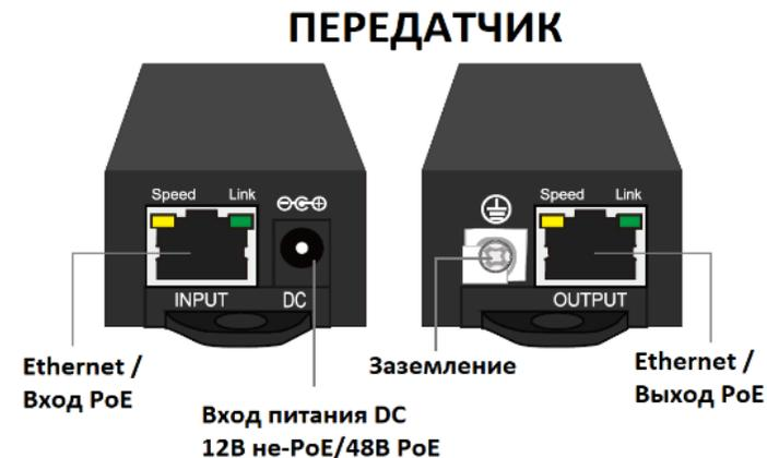
Рис. 2.1. Расположение и назначение элементов коммутации. Передатчик.
