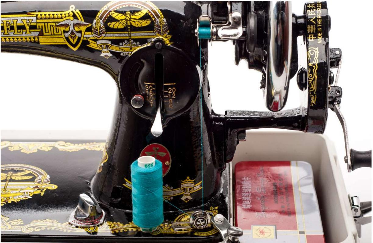
Для намотки шпульки служит особая моталка, прикрепленная к задней части корпуса машины около маховика. Моталка работает совместно с нижним натяжным устройством для нити на правом углу платформы.
