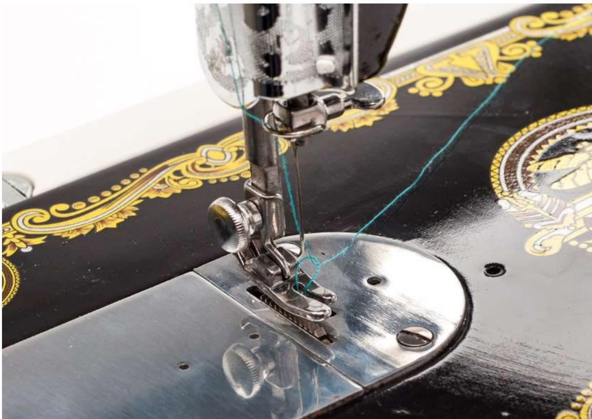
Прежде чем начать шить, нужно вытянуть нижнюю нитку наружу. Для этого берут левой рукой за конец игольную нитку, не натягивая ее, затем поворачивают на себя маховик машины для того, чтобы игла опустилась сначала в отверстие игольной пластинки, захватила нижнюю челночную нитку и затем опять поднялась в свое верхнее положение. После этого нужно потянуть за конец игольную нитку и через отверстие в игольной пластине вытянуть нижнюю нитку вверх.
