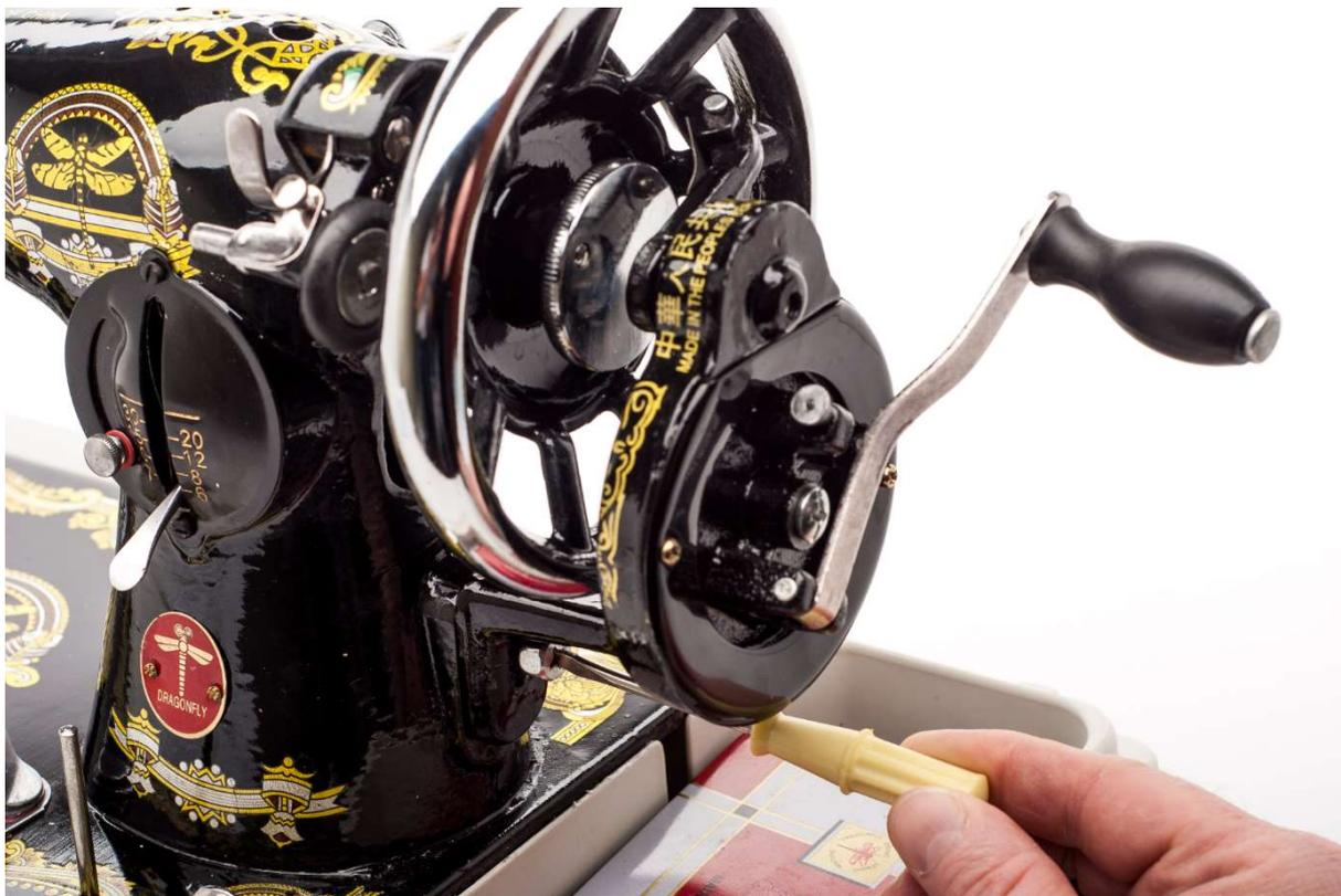
13. Переведите ручку редуктора из сложенного состояния в рабочее, зафиксировав ее специальным фиксатором. Для этого оттяните стержень фиксатора, разложите ручку и вставьте ее в рабочий паз, отпустите фиксирующий стержень чтобы закрепить рукоятку.
