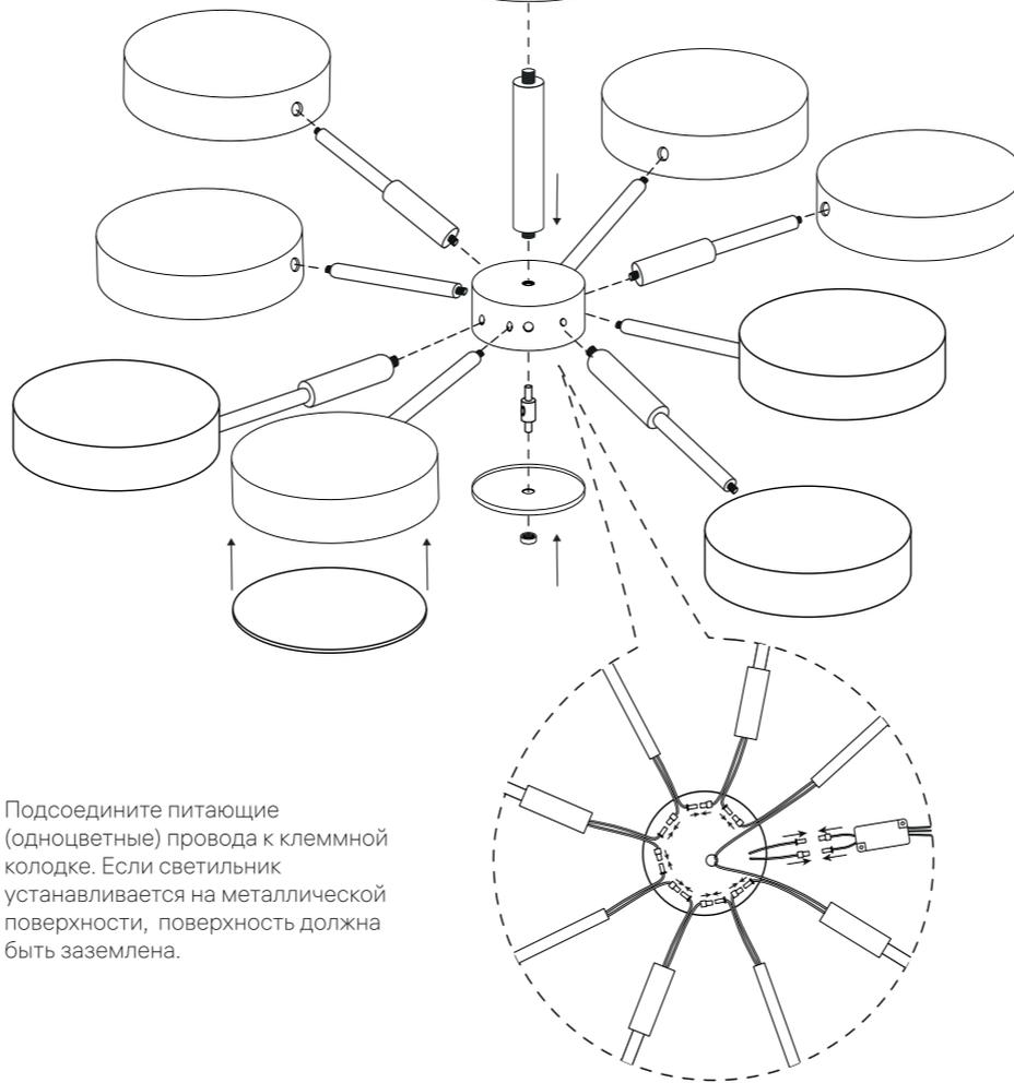
Подсоедините питающие (одноцветные) провода к клеммной колодке. Если светильник устанавливается на металлической поверхности, поверхность должна быть заземлена.
