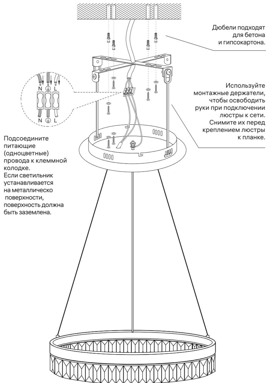
Подсоедините питающие (одноцветные) провода к клеммной колодке. Если светильник устанавливается на металлическую поверхность, поверхность должна быть заземлена.
