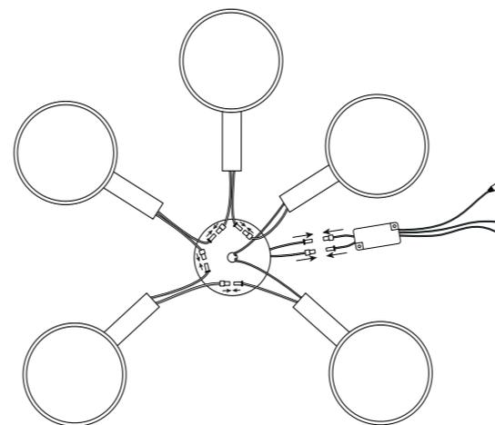
Схема подключения элементов плафона
