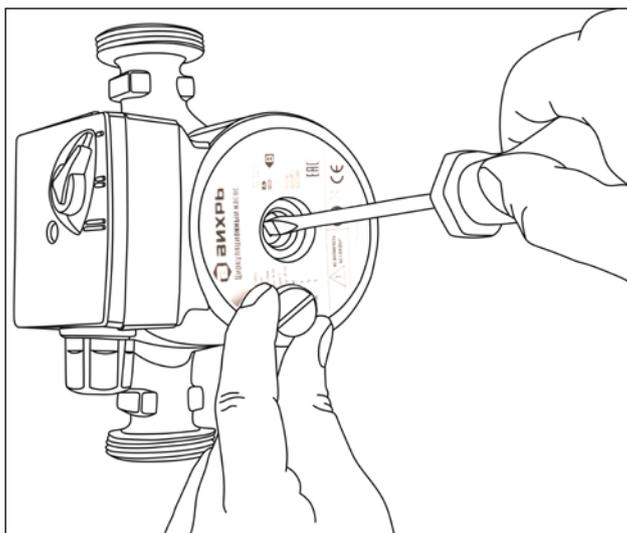
Рис.8 Устранение блокировки ротора
