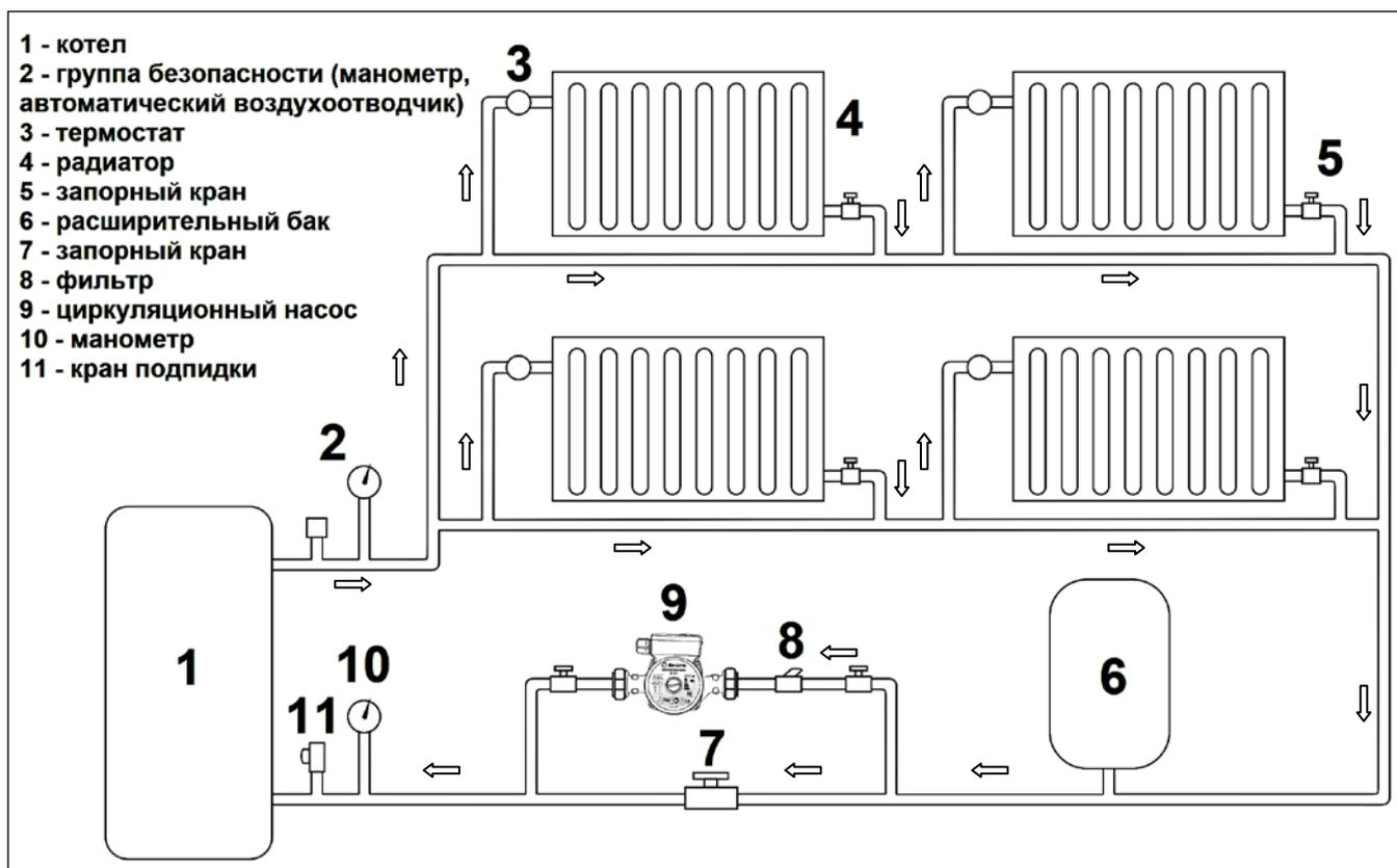
Рис. 2 Схема монтажа
