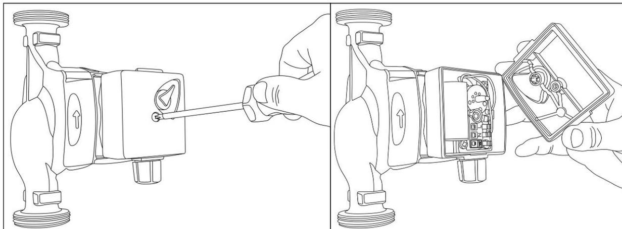
Рис. 4 Снятие крышки
