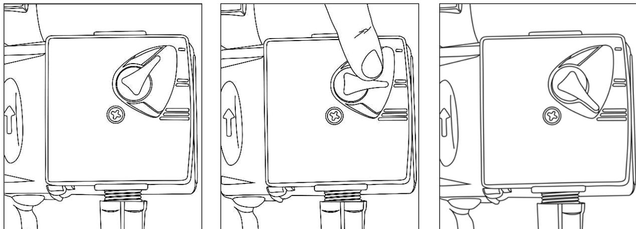
Рис. 6 Переключатель скоростей работы насоса
