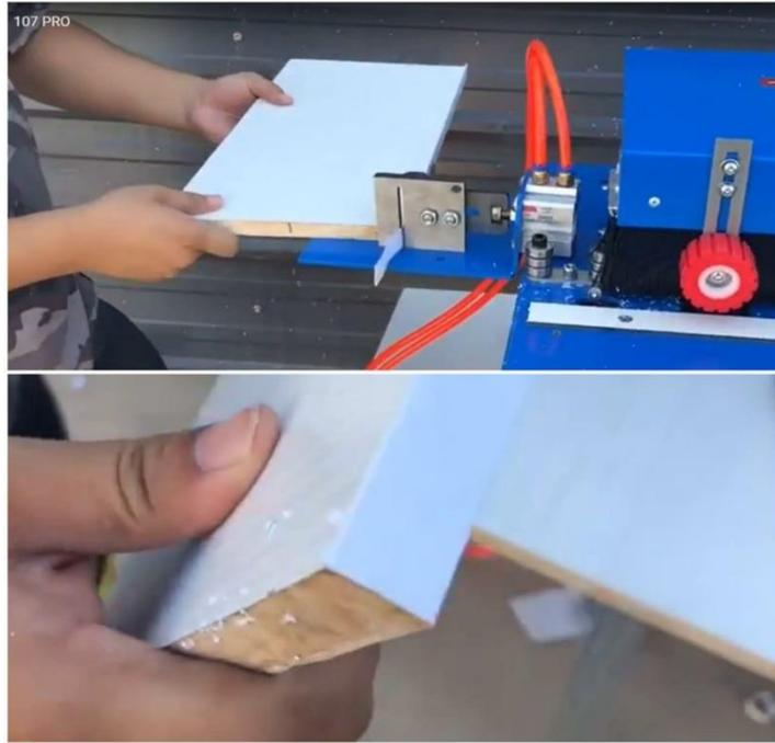
Полировка сверху и снизу заготовки осуществляется в автоматическом режиме от концевого выключателя только при работе с прямолинейными заготовками
