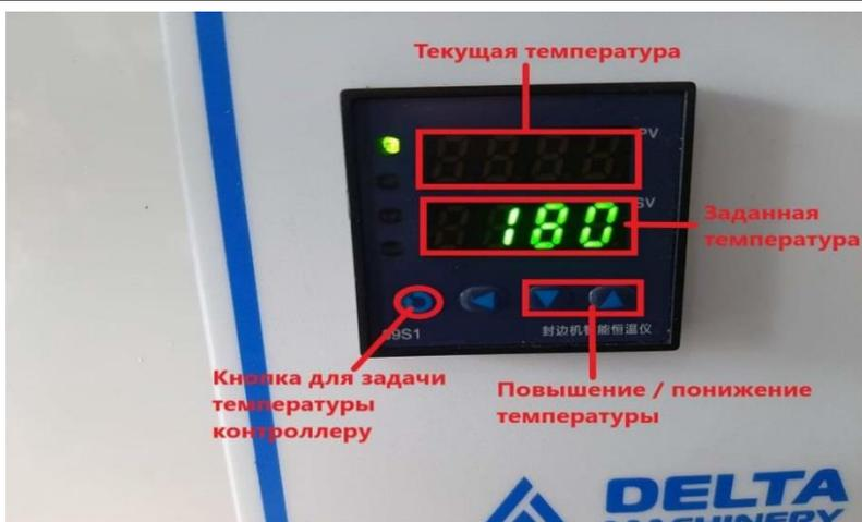
Когда нагрев достигнет установленной температуры, нажмите на выключатель двигателя, чтобы начать работу.
