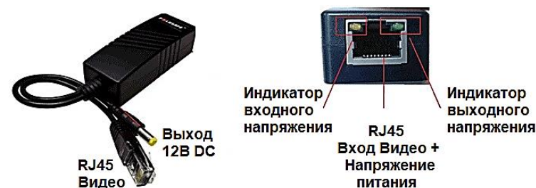
Рис. 1 Общий вид Изделия и назначение его контактных выводов и гнезд
