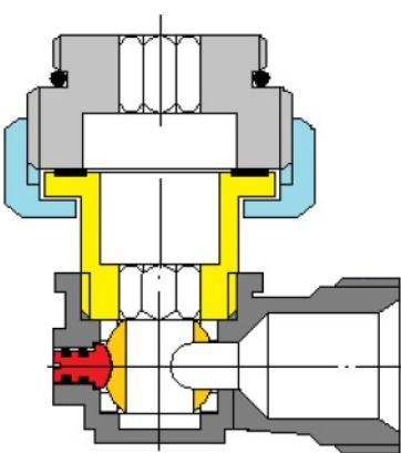
Соединение трубопровода и узла подключения производится к корпусу 1 посредством фитинга с внутренней резьбой G3/4. Присоединение к радиатору производится посредством штуцера 5 (наружная резьба G1/2) и накидной гайки 3. На штуцере 5 имеется уплотнение 7 предназначено для герметизации соединения с радиатором. Для обеспечения герметичности соединения штуцера 5 с патрубком 4 используется прокладка 8.
