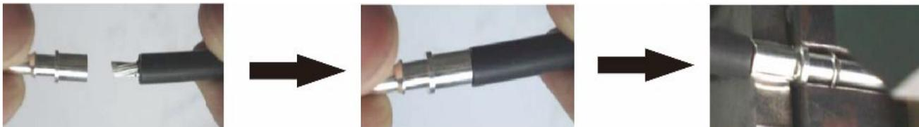
Вставьте собранный кабель в корпус штыревого разъема, как показано на следующем рисунке:
