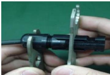
Шаг 4. Провода, соединяющие фотоэлектрические модули и входные фотоэлектрические разъемы на инверторе должны быть присоединены в правильной полярности. Присоедините положительную клемму (+) кабеля к положительной клемме (+) входного фотоэлектрического разъема. Присоедините отрицательную клемму (-) кабеля к отрицательной клемме (-) входного фотоэлектрического разъема.
