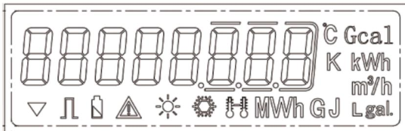
Рис. 1 – Внешний вид дисплея теплосчетчика Sanext Mono CU
