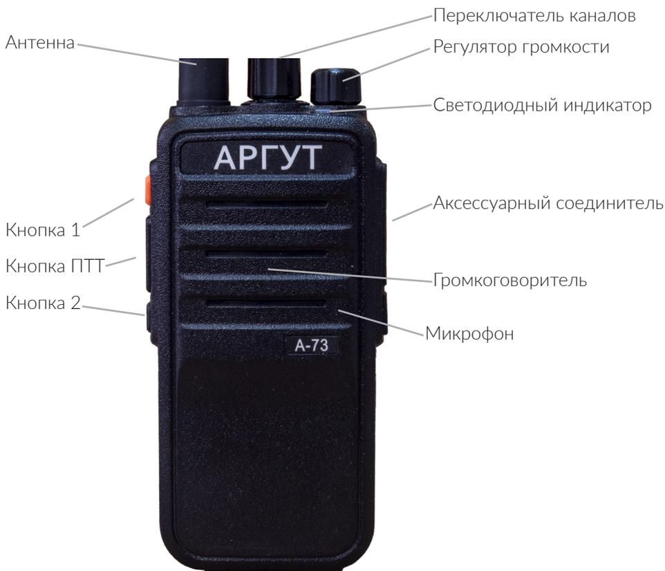
Рис. 1. Расположение органов управления, индикации и соединителей.
