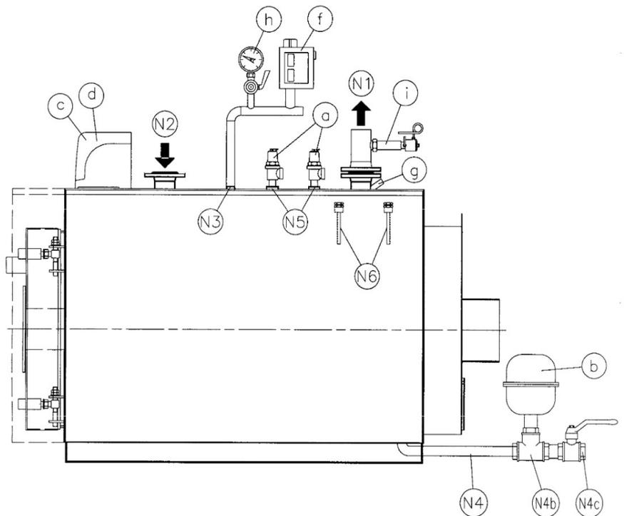
Гидравлическое давление после редукционного клапана на трубопроводе подачи не должно превышать рабочего давления, указанного на табличке детали (котел, бойлер и т.д.).
