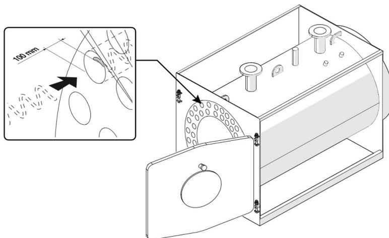
**ВАЖНО:** Края турбулизаторов очень острые. При проведении работ необходимо пользоваться защитными перчатками (в соответствии с действующими нормативами).
