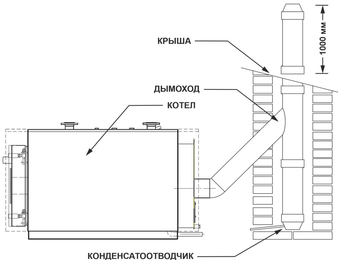
**ВАЖНО:** Дымовой канал должен иметь диаметр, равный соединению с котлом, или больше соединения с котлом.
