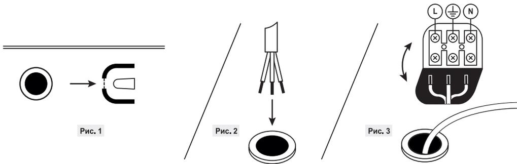
4. Пропустите кабель через отверстие в корпусе панели (Рис. 2).
