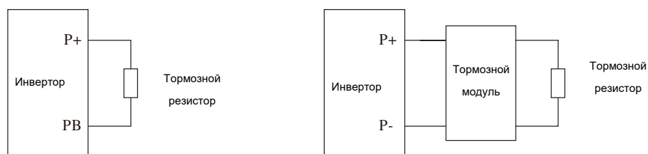
Рис. 2-10 Подключение тормозного модуля и резистора
