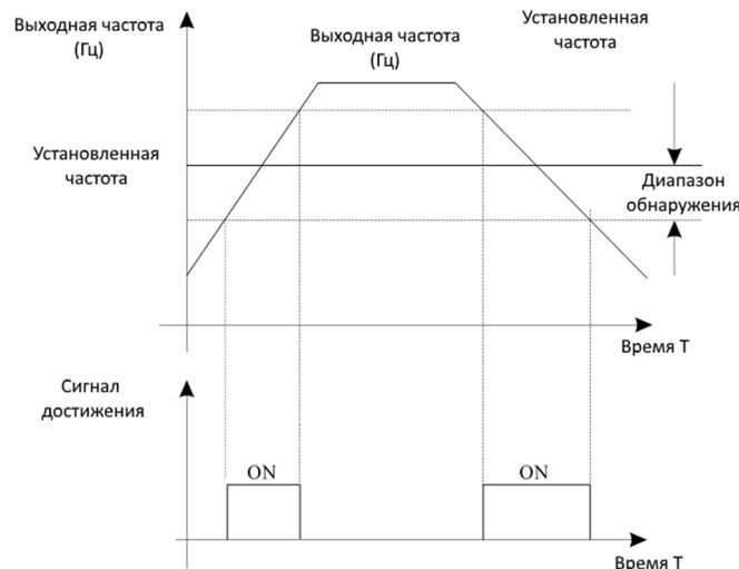
Рис. 5-15 Диапазон обнаружения достигнутой частоты
