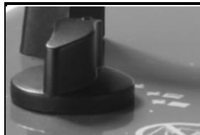
**5.4.** Тепловая пушка включается, когда переключатель установлен на один из режимов работы двигателя.
