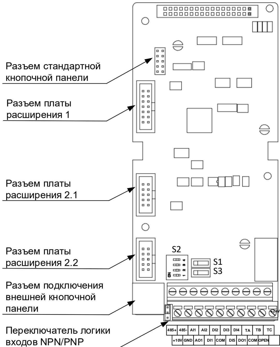
Рисунок 2-2 Расположение клемм управления и DIP-переключателей
