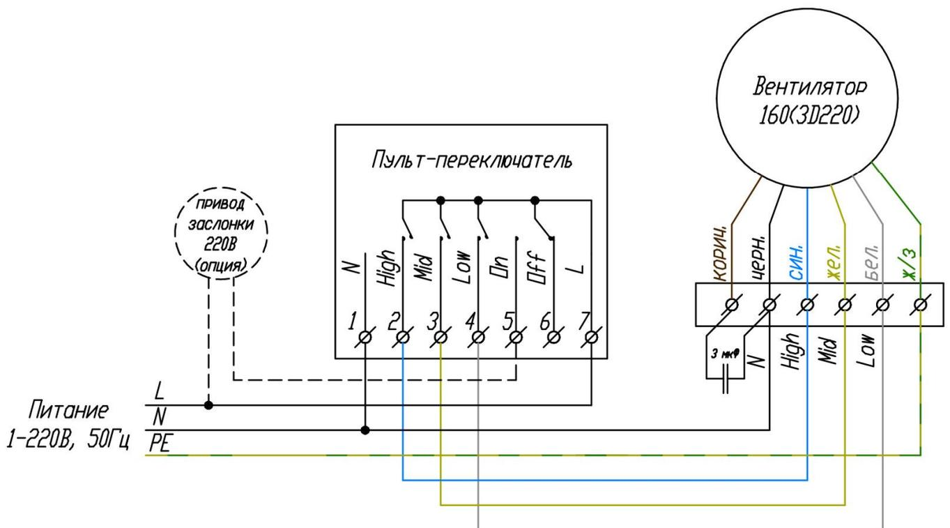
На клемму 5 (Op) пульта-переключателя коммутируется фаза (L) при включении вентилятора на любую скорость. Данную клемму можно задействовать для открытия привода заслонки (с питанием 220В).
