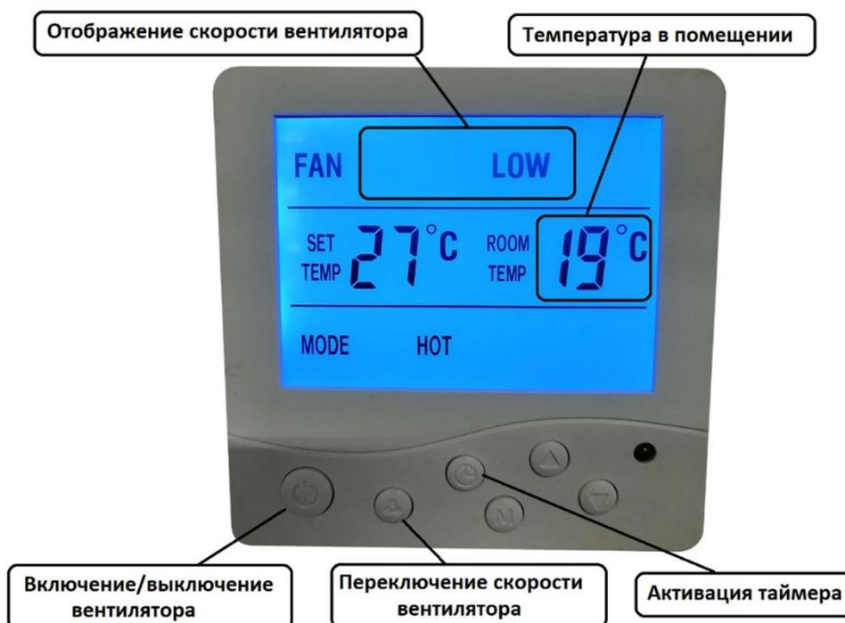
В пульте предусмотрена возможность настроить отложенный запуск или останов (таймер). При активации таймера настраивается время, по истечении которого произойдет выбранное действие:
