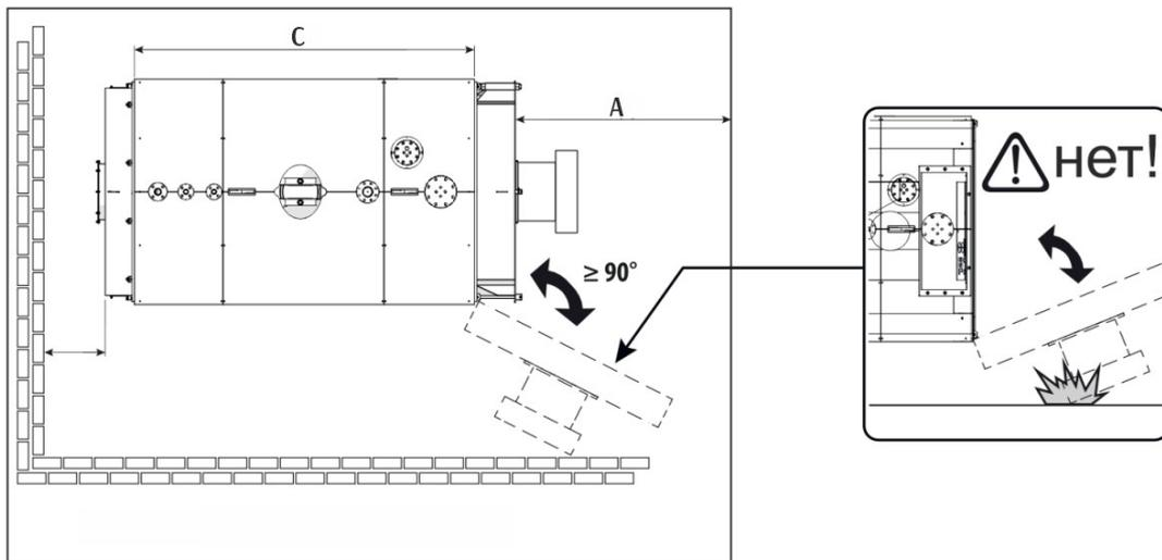
**ВАЖНО:** Необходимо обеспечить доступ к передней части котла, к месту расположения дымогарных труб для извлечения турбулизаторов с целью чистки дымогарных труб и их замены в случае необходимости.
