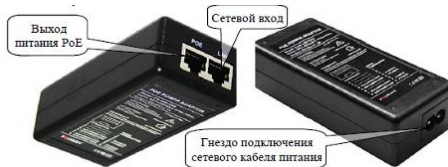
Рис. 1. Общий вид Изделия и назначение его контактов и разъемов.
