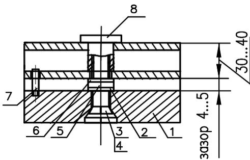
1-Крышка, 2- Шайба 8, 3- Винт фиксатора М6, 4- Втулка, 5- Шайба резиновая, 6- Шайба 6, 7- Штифт резьбовой, 8- Фиксатор
