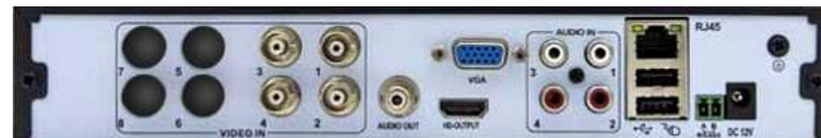
Рис. 1. Расположение разъемов на задней панели Прибора
