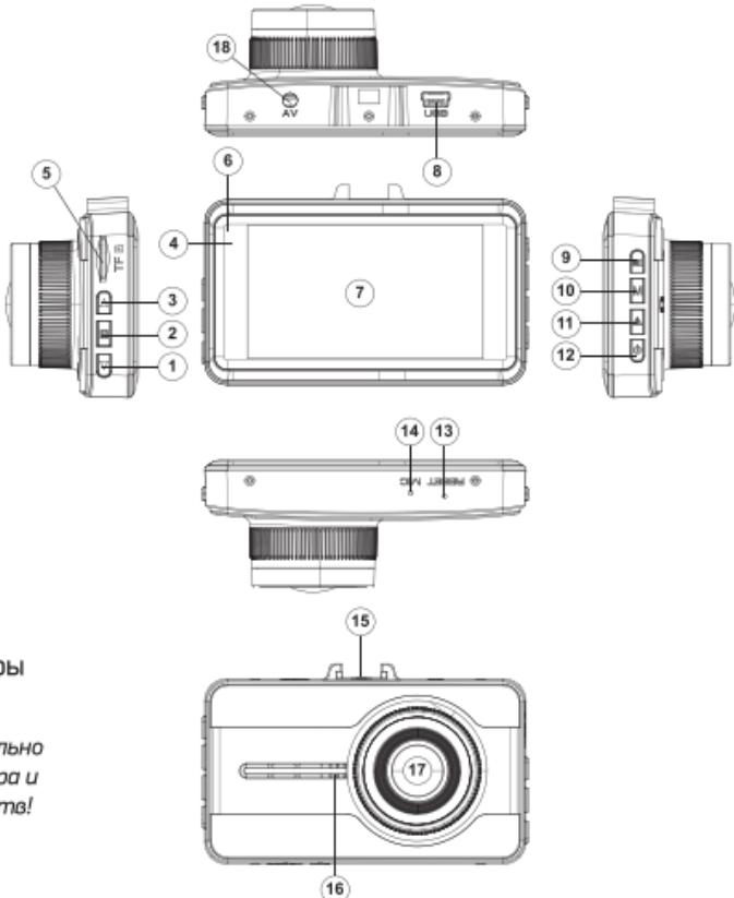
**ВНИМАНИЕ!** Порт 18 предназначен исключительно для подключения внешней камеры регистратора и не поддерживает подключение других устройств!
