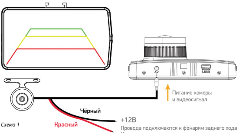
Камера имеет два интерфейса подключения. Первый – питание самой камеры и видеосигнал. Подключается к разъёму (18) регистратора. Второй – два провода, красный (+) и чёрный (GND): питание подсветки камеры и переключение камеры в режим парковки, при котором происходит наложение на изображение камеры изображения парковочной трапеции. Эти два провода подключаются к фонарю заднего хода.
