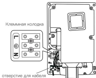
Подключение кабеля. Провод фазы подключить к клемме L. Нулевой провод подключить к клемме N.
